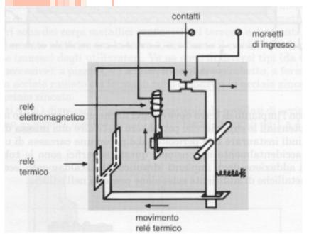
L'interruttore magnetico è un relè elettromagnetico che interviene in caso di cortocircuito o di forte sovraccarico , aprendo all'istante l'interruttore e quindi il circuito collegato. L'elevato valore di corrente , infatti, circolante nel circuito determina un elevato valore del campo magnetico prodotto dall'avvolgimento del relè che permette lo sganciamento di un dispositivo con conseguente apertura del circuito.
