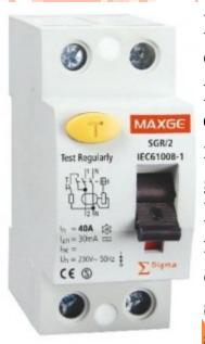
L'interruttore differenziale, se presente nel nostro quadro elettrico d'appartamento, è facilmente riconoscibile per la presenza di un pulsante, utile per la manutenzione, contrassegnato dalla lettera T (può avere forma diversa da quello nella foto). I cavi che conducono la corrente elettrica sono generalmente due: la fase e il neutro.
